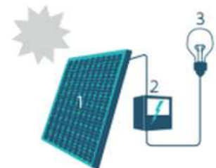
1. Zonnepaneel | 2. Omvormer | 3. Elektrische toestellen
